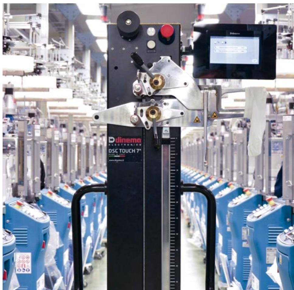
DSC TOUCH 7" è alimentato da batterie ricaricabili ed è quindi lo strumento di misura ideale per essere spostato all'interno delle aree produttive.
