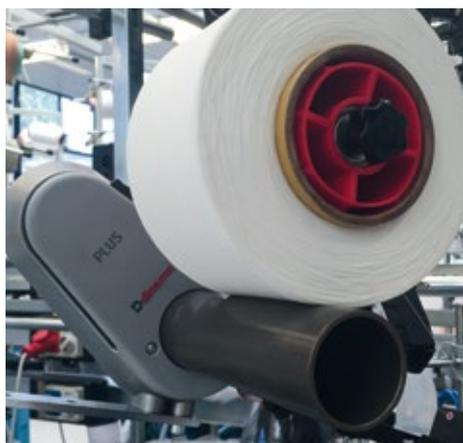
L'esperienza di Dinema nei controlli motori ha permesso di realizzare un dispositivo estremamente preciso che, grazie al controllo di camme elettrica, garantisce un prodotto finale di elevate qualità. PLUS, se abbinato ai dispositivi GRYF per l'alimentazione del filo di fondo, può essere programmato con la "formula di stiro" condizione necessaria per ottenere capi di elevata qualità.
