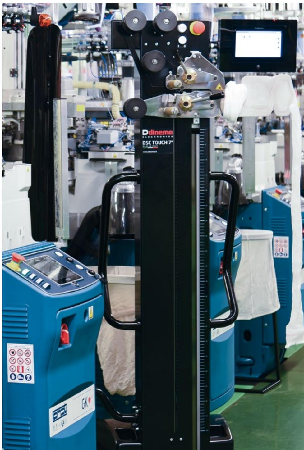
È possibile utilizzare DSC TOUCH 7" in modo automatico e quindi ottenere non solo la misurazione ma anche l'eventuale correzione in automatico del programma di lavorazione della macchina, riportando il capo tessile alla taglia desiderata.
