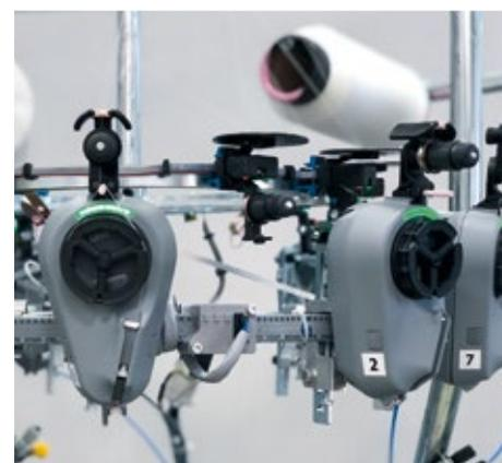
Il sistema di controllo, basato su un sensore e su un motore ad elevate prestazioni, permette di impostare e mantenere costante la corretta tensione del filo, adattandosi alla specifica lavorazione e ai diversi tipi di filato.
